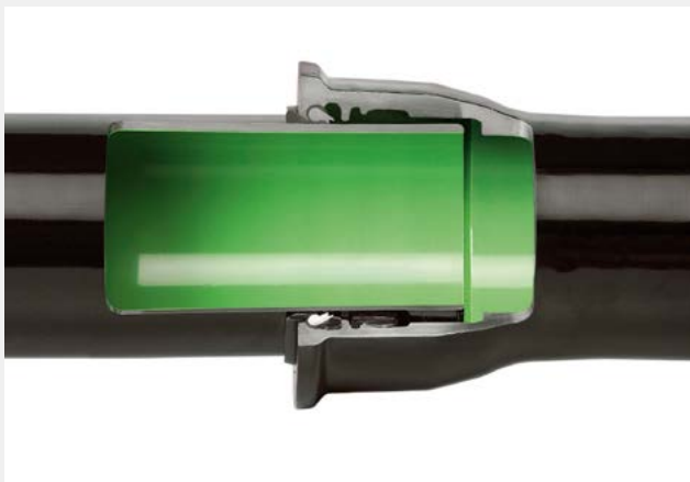
Fig. 13 Verrouillage vonRoll HYDROTIGHT intérieur avec une résistance électrique élevée pour éviter la conductivité électrique longitudinale
