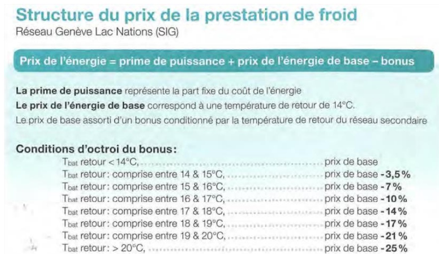
Figure 4 : Structure de prix de la prestation de froid
