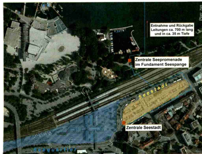
Schematische Darstellung der geplanten Seewassernutzung in Bregenz.
